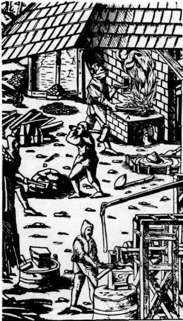
Die Verfahren der Eisengießer (nach Agricola). Bauerrennteuer zum Ausschmelzen des Roheisens. Das Her- ausschlagen der Schlacke und die Bedienung der Blase- bälge geschahen nur durch Muskelkraft.
