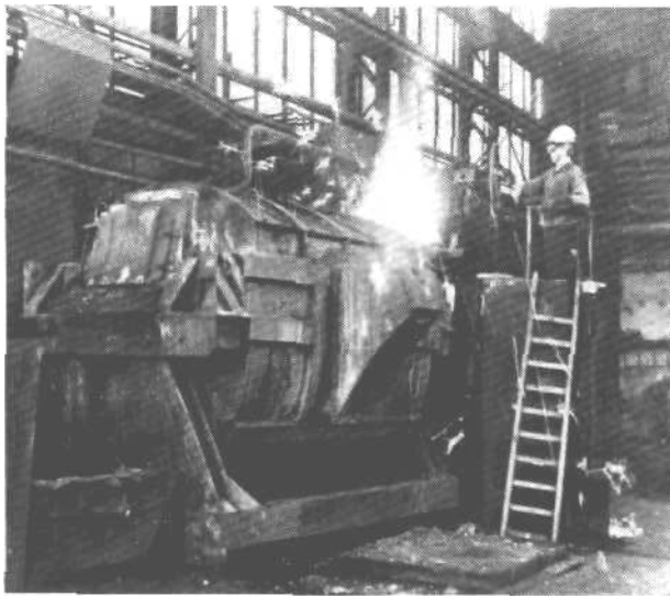
Füllen des 8-t-Induktionsofens mit flüssigem Eisen (1979).
